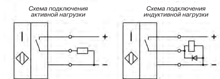
Рис. 6.4. Схема подключения датчика со структурой P (pnp - «общий -») (для датчиков ВК WF63-31-P-3-400-ИНД-3В-1-НТ или ВК WF63-31-P-3-400-ИНД-3В-1-НТ2)
